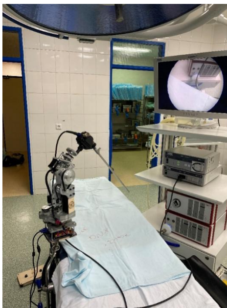
Рисунок 3.3 – Устройство управления хирургической камерой (Патент № 2775876)
